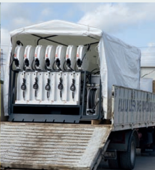
Unidade de serviço de campo, enroladores de mangueira séries 502 e 505 e bombas PumpMaster 2.
