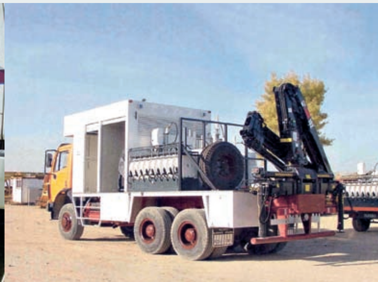
Camião de serviço, enroladores de mangueira série 502, bombas de óleo PM4 e bombas de massa PM3+3.
